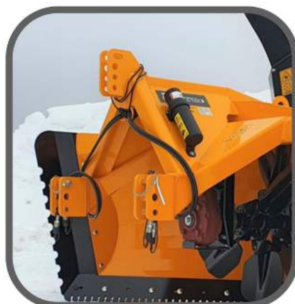
Vahva vetopää kat 2 ja kat 3 kiinnityksellä (mallit 241, 242 ja 260R)
