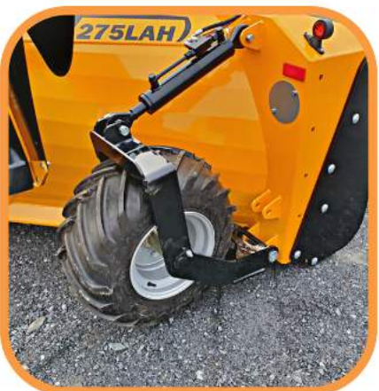
Hydrauliset tukipyörät 26x12 virtauksen jakovoimalla. Sarja 2 kpl.
