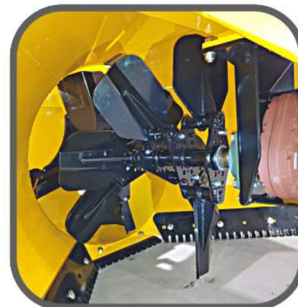
Tehokas laparoottori murtopulteilla. Lavat 500HB Hardox (mallit 241 ja 242)
