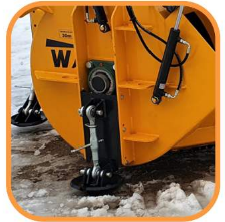
Säädettävät tukijalakset 500HB Hardox (malleissa 241, 242 ja 260R vakiona)
