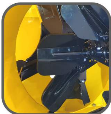
Vahvarakenteinen heittosiivikko murtopulteilla (mallit 241, 242 ja 260R)
