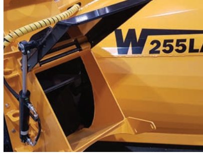
Stora utloppsöppningar för snön
