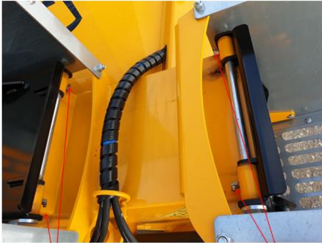
Lumenohjauksen (1) saranoiden rasvanipat Lumenohjauksen (2) saranoiden rasvanipat
